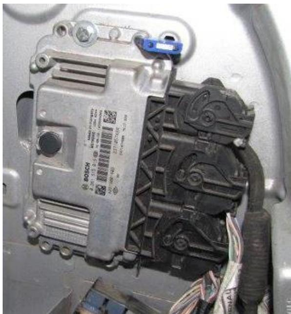
Slika 17 – plombe računalnika / Figure 17 - Computer seals
